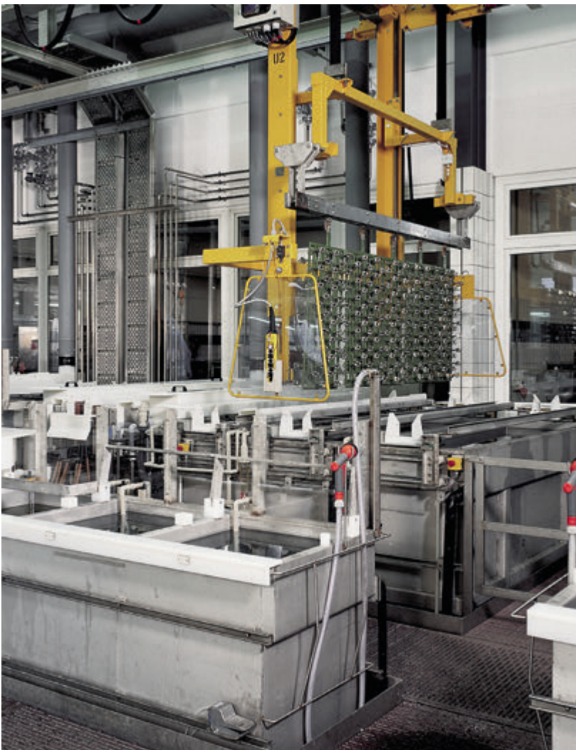
Elektropolier-Automat mit davor befindlicher manueller Anlage Automatic electroplishing plant with manual plant in front
