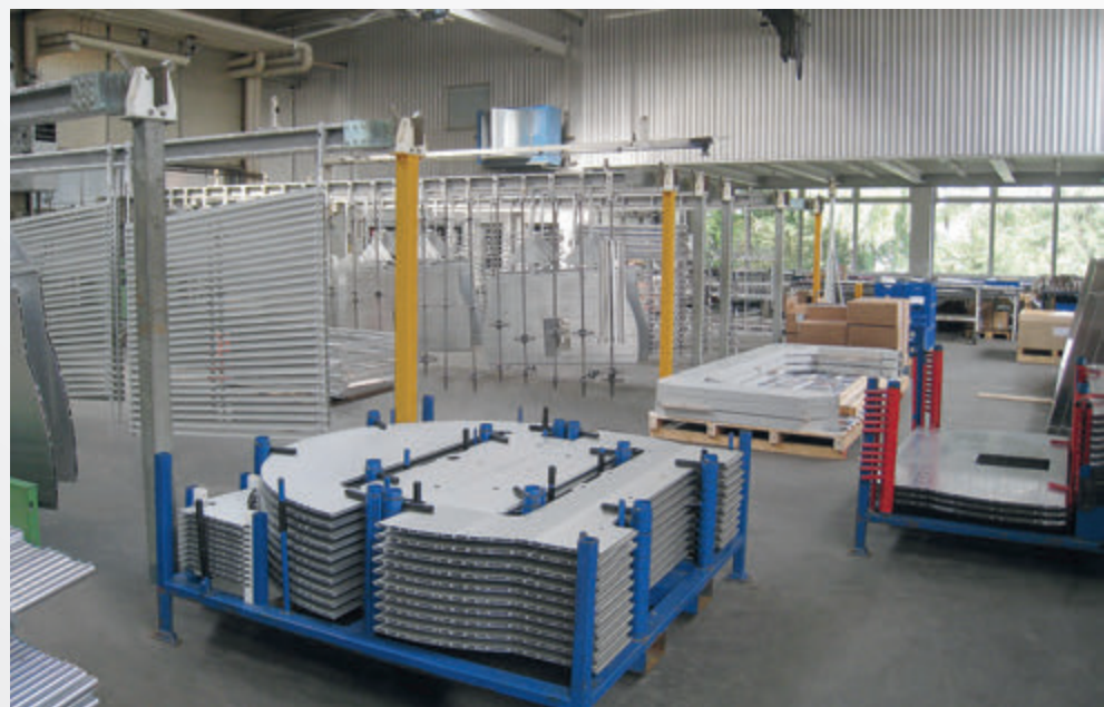
Kontaktier- und Kontrollbereich der Eloxalanlage Contact and checking area at the anodizing plant
