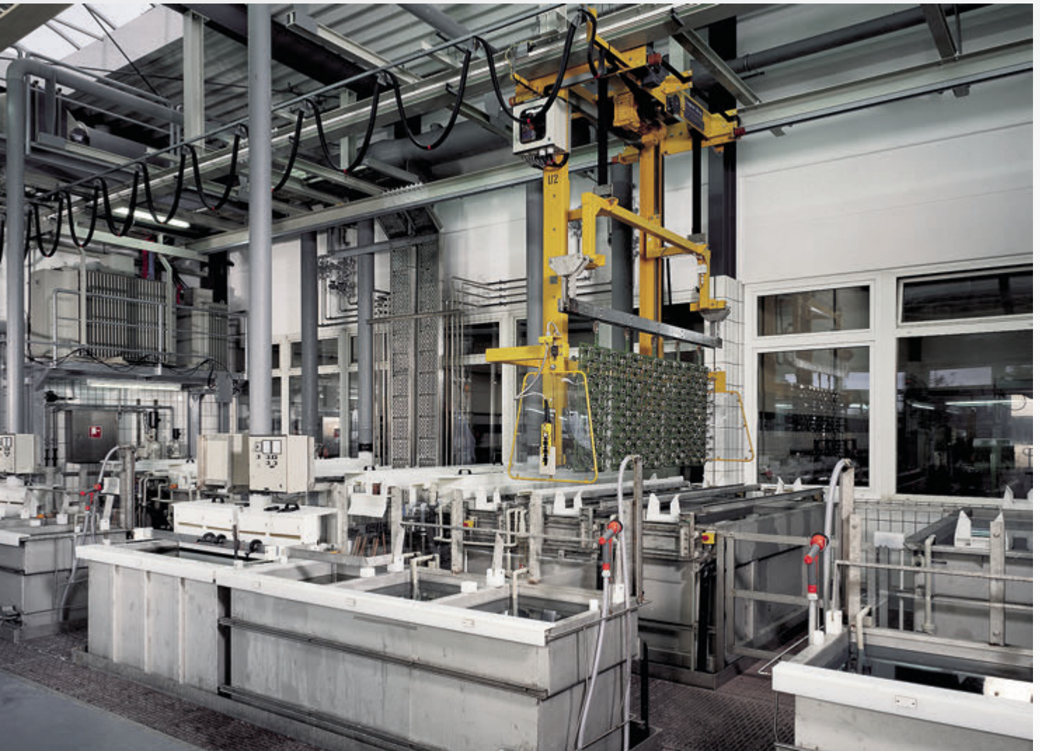
Elektropolier-Automat mit davor befindlicher manuellen Anlage Automatic electropolishing plant with manual plant in front
