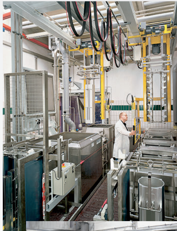
Teilansicht Reinbeizautomat Partial view of the clean pickling automat
