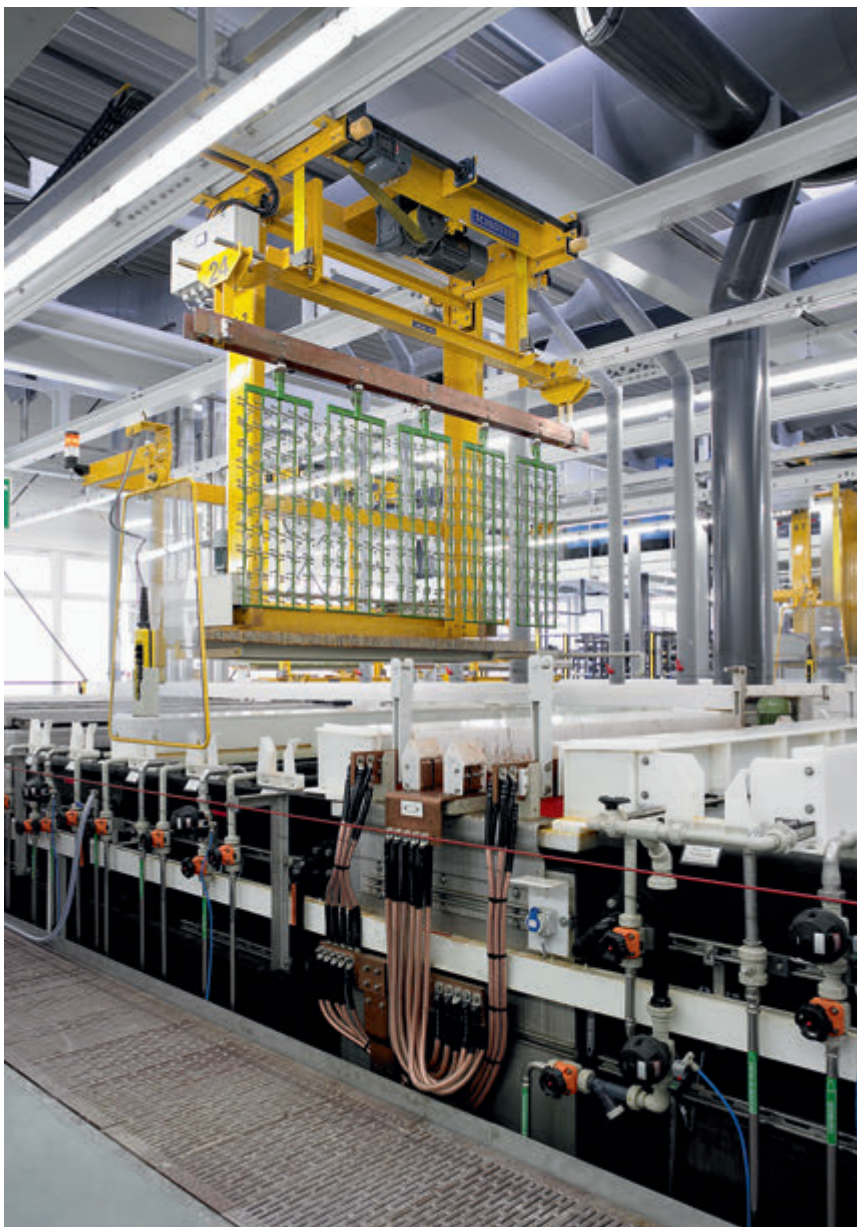
Werkbild: Rohde Galvanoautomat für Gestellartikel Picture made by: Rohde Automatic electroplating plant for frame articles
